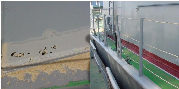
Герметизация шва между палубой и корпусом судна
