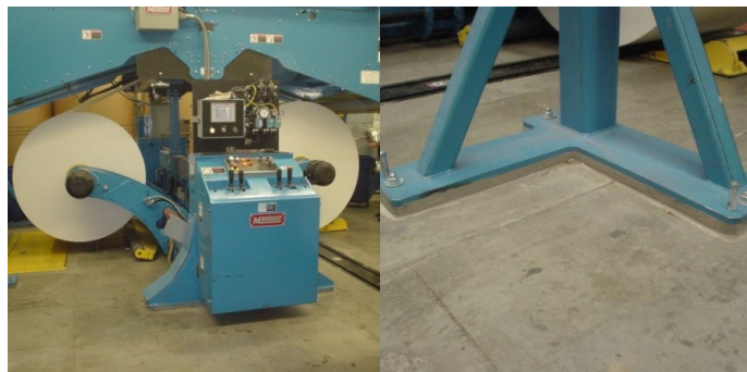
Установка гидравлической машины для резки бумаги
