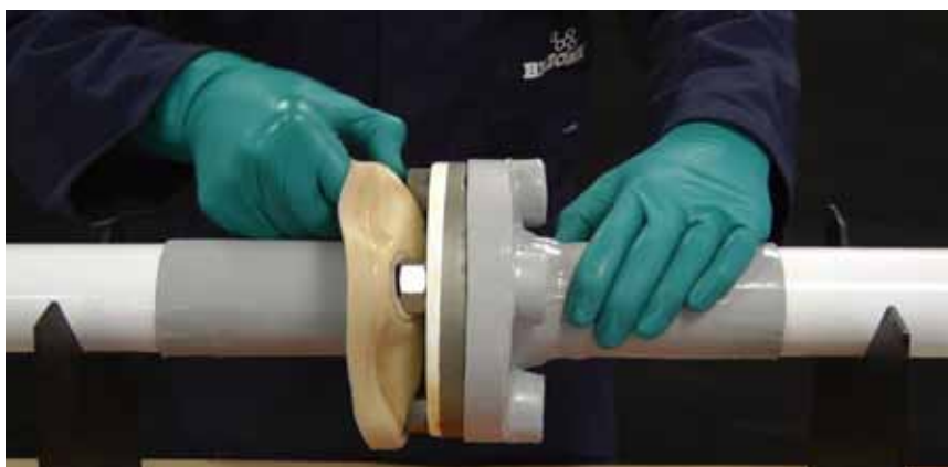
Снятие защитной системы для проверки, после инспекции система восстанавливается
